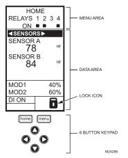
Fig. 20. LCD Display - Home Screen And Keypad.
