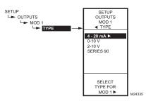
Fig. 56. Setup - Outputs - Mod Out - Type.
