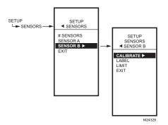
Fig. 50. Setup - Sensors - Sensor B Menu.
